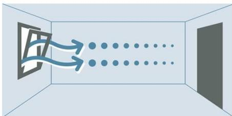
Eine alleinige Kipplüftung ist weitgehend wirkungslos, da durch sie kaum Luft ausgetauscht wird.
